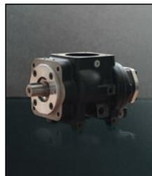
Der Schraubenblock hat ein zeitgemäßes und energieeffizientes Rotorendesign. Wenn das Schraubenpaar rotiert, bildet das Öl, unter dem überschüssigen Druck, einen dünnen Ölfilm zwischen den Rotationskörpern. Dies sorgt für eine kontaklose Rotation und einer damit verbundene Langlebigkeit.
