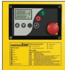
Die Steuerung „e-Log“ kontrolliert den Automatikmodus des Kompressors. Außerdem liefert sie dem Bediener alle wichtigen Informationen über den Prozessablauf, wie Betriebsdruck, Temperatur des Luft-Öl Gemisches, Prozessdauer etc.
